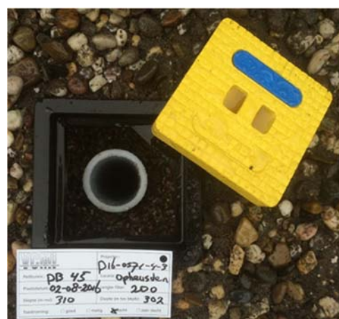
Tijdelijke peilbuis nieuwbouwlocatie
