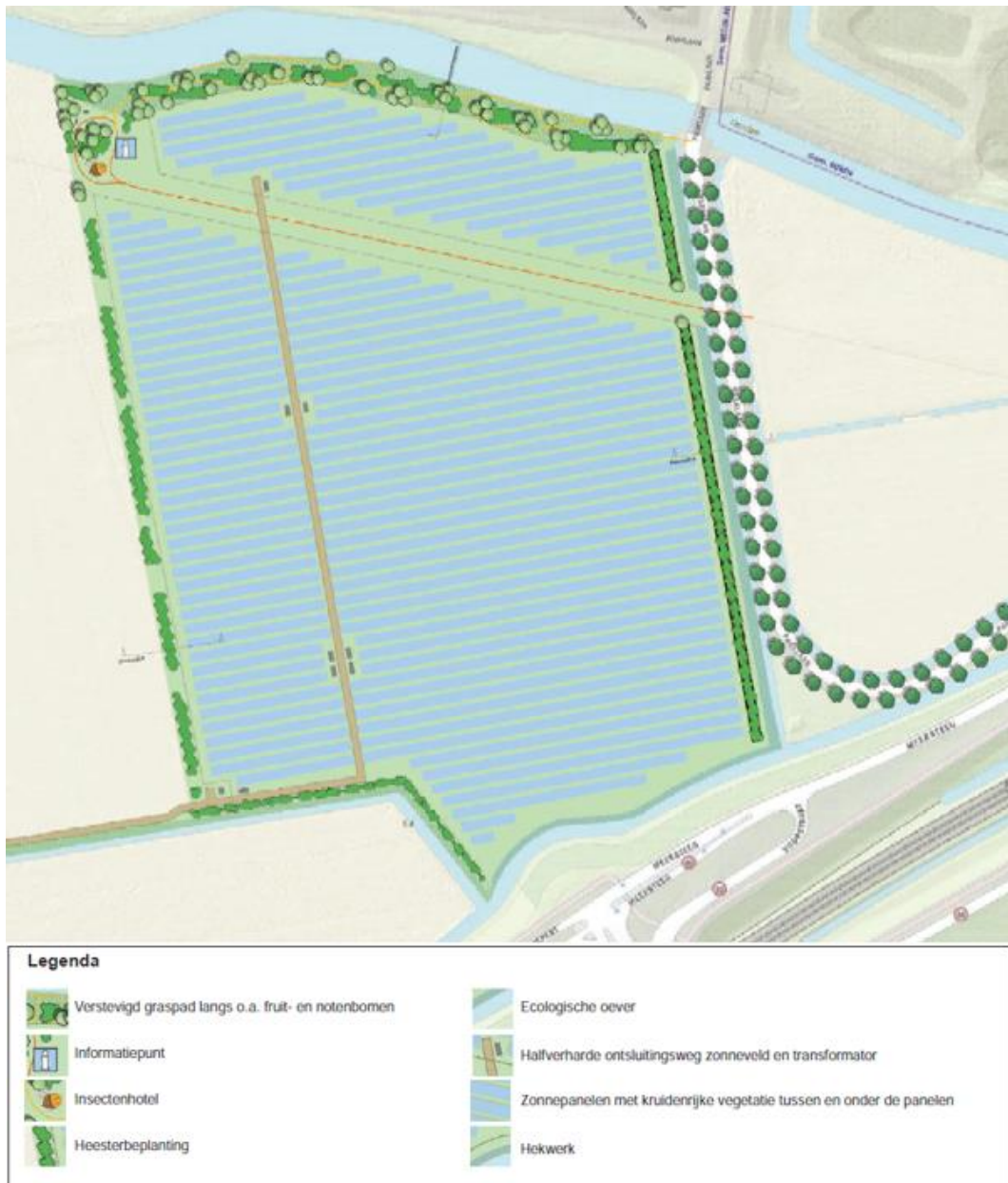
Afbeelding 4: Weergave inrichtingstekening (overzicht) van het zonneveld
